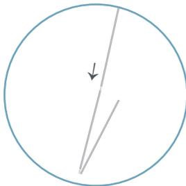
Stecken Sie die geteilte Stützstange zusammen. Achten Sie darauf, dass die einzelnen Teile komplett zusammengesoben sind.
